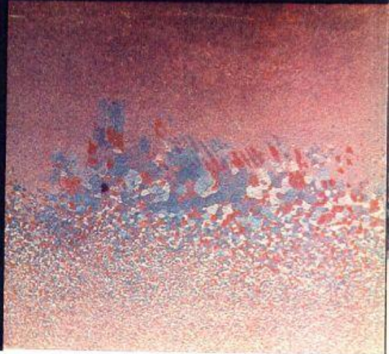
A RELÉ-ACÉL MINTA eredetileg egyenletes kristályszerkezetűt a rövidebb oldalával párhuzamosan ható hengerlési (nyomási), majd az ezután erre merőlegesen ható hőkezelési (hőmérsékleti) inhomogenitások együtt rendezik kedvezőbbé. A megfelelő hengerlési-hőkezelési gyártási megoldást a kristályméretek és irányok elemzése útján választhatja ki a szakember
