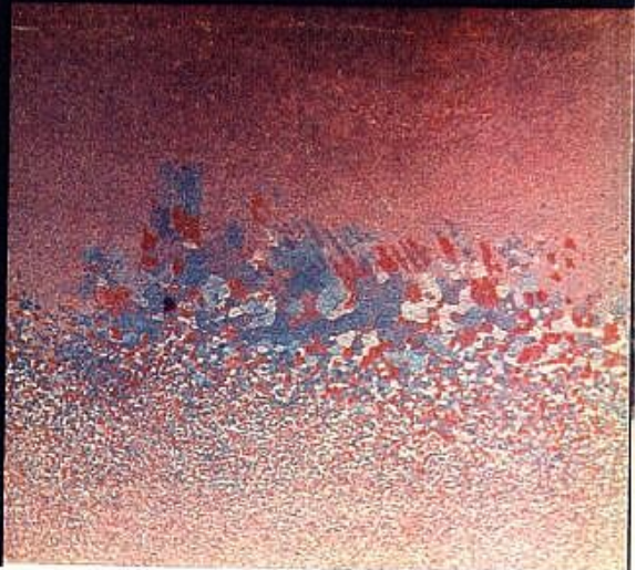
A RELÉ-ACÉL MINTA eredetileg egyenletes kristályszerkezetűt a rövidebb oldalával párhuzamosan ható hengerlési (nyomási), majd az ezután erre merőlegesen ható hőkezelési (hőmérsékleti) inhomogenitások együtt rendezik kedvezőbbé. A megfelelő hengerlési-hőkezelési gyártási megoldást a kristálméreték és irányok elemzése útján választhatja ki a szakember
