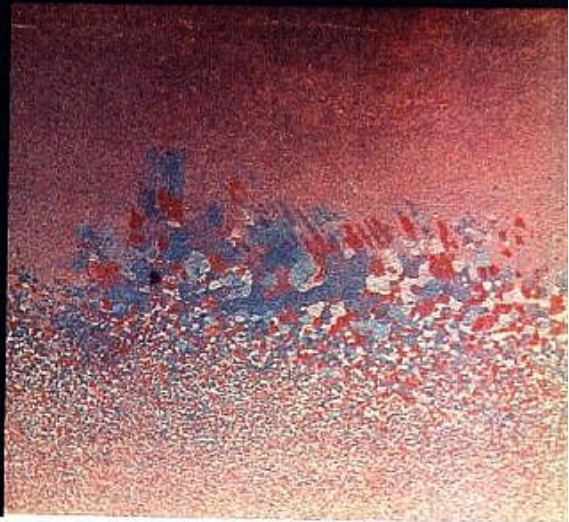
A RELÉ-ACÉL MINTA eredetileg egyenletes kristályszerkezetű a rövidebb oldalával párhuzamosan ható hengerlési (nyomási), majd az ezután erre merőlegesen ható hőkezelési (hőmérsékleti) inhomogenitások együtt rendezik kedvezőbbé. A megfelelő hengerlési-hőkezelési gyártási megoldást a kristályméretek és irányok elemzése útján választhatja ki a szakember
