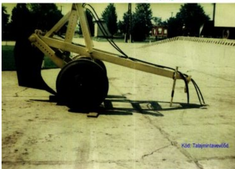
Folyamatos mintavétel 5 talajmélységből
