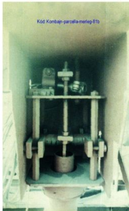
Üzemi kombájnbba beépített parcella termés mérő adapter létesítmény terv-modell. All Rights Reserved! Tejfalussy András dipl. mérnök feltaláló, Sulyok László technikus, Vass László mérnök-fizikus, Hungary, 1981.
