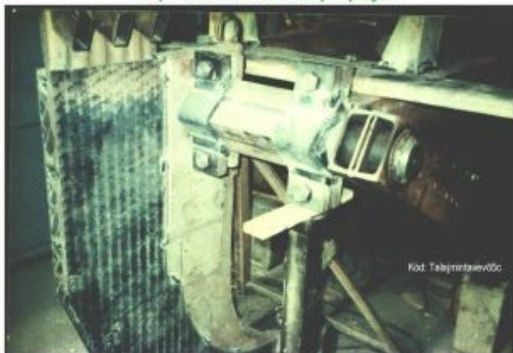
Folyamatos mintavétel 5 talajmélységből
