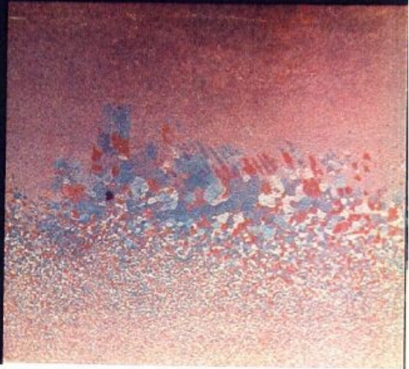
A RELÉ-ACÉL MINTA eredetileg egyenletes kristályszerkezetűt a rövidebb oldalával párhuzamosan ható hengerlési (nyomási), majd az ezután erre merőlegesen ható hőkezelési (hőmérsékleti) inhomogenitások együtt rendezik kedvezőbbé. A megfelelő hengerlési-hőkezelési gyártási megoldást a kristályméretek és irányok elemzése útján választhatja ki a szakember
