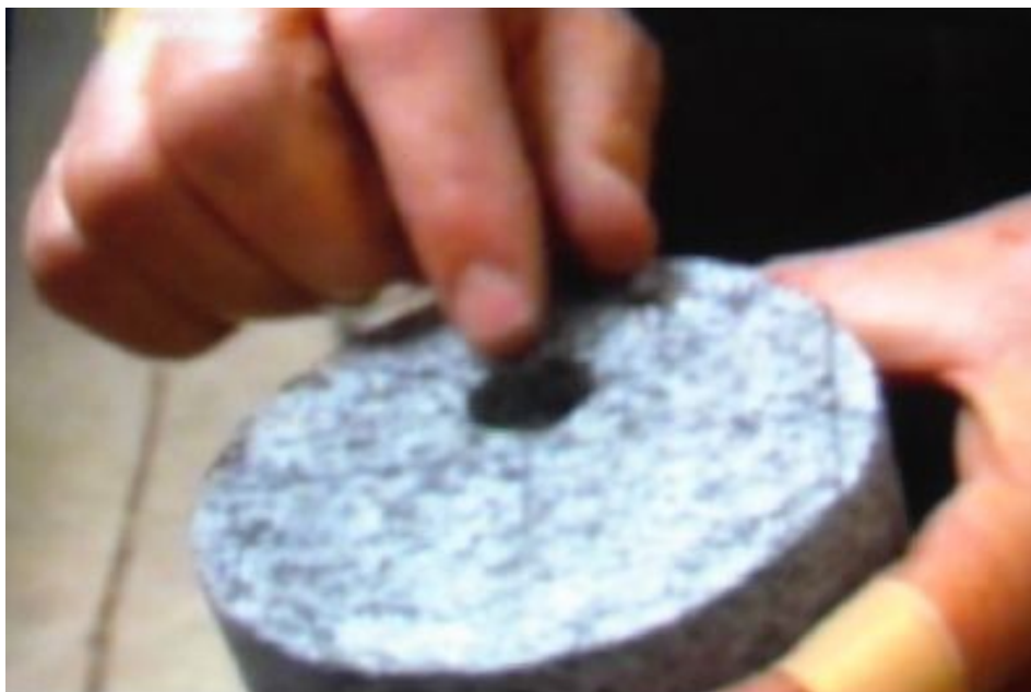
A POTTER DRILLING CÉG ÁLTAL "LÁNGSUGÁRRAL" GRÁNITBA FÜRT FURAT. KÜLÖNLEGES ÉPÍTMÉNYEK, GEOTERMIKUS ERŐK National Geographic TV 2008. április 14. (Kód: Geoterm-LangsugarFurat2)
